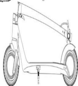
2. Sæt det fritlagte kabel ind i styrstangen. Sæt derefter styret ned i styrstangen. Fastgør styret til styrstangen med skruerne ved hjælp af sekskantnøglen.
