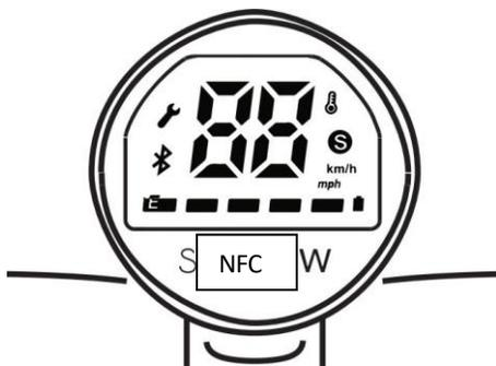
Pentru Android, deschideți aplicația SoFlow, conectați scuterul și atingeți NFC pentru a-l bloca sau debloca. Pentru iOS, cu excepția Android, trebuie, de asemenea, să faceți clic pe notificarea de mai jos pentru a vă bloca sau debloca scuterul.
