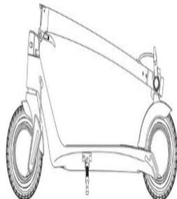
2. Inserite il cavo a vista nel piantone anteriore. Quindi inserite anche il manubrio nel piantone anteriore. Utilizzate l'attrezzo e le viti per imbullonare il manubrio al piantone anteriore.
