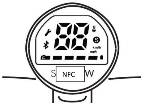
Para Android, abra la aplicación soflow, conecte su scooter, y luego toque NFC para bloquearlo o desbloquearlo.
