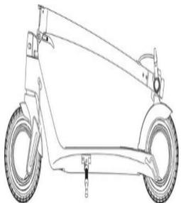
2. Sätt in den synliga kabeln i styrstången. Sätt därefter i styret i styrstången. Använd verktyget och skruvarna för att fästa styret i styrstången.
