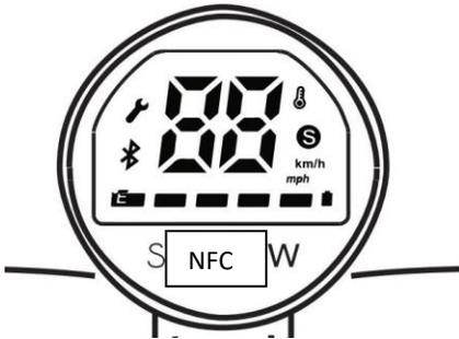
Open voor Android de SoFlow-app, sluit je scooter aan en tik vervolgens op NFC om hem te vergrendelen of te ontgrendelen. Open voor Android de SoFlow-app, sluit je scooter aan en tik verplaatst op NFC om hem te ontgrendelen of te ontgrendelen.
