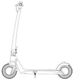
2. Helyezze be a szabadon hagyott kábelt az első rúdba. Ezután helyezze be a kormányt is az első kormányba. A szerszám és a csavarok segítségével csavarozza a kormányt az első kormányhoz.
