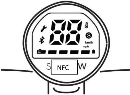
Öffnen Sie für Android die SoFlow App, verbinden Sie Ihren Roller und berühren Sie NFC, um ihn zu sperren oder zu entsperren. Für iOS, außer Android, müssen Sie auch auf die unten angezeigte Benachrichtigung klicken, um Ihren Roller zu sperren oder zu entsperren.
