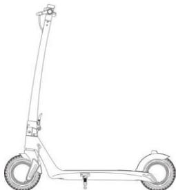
2. Introduceți cablul expus în bara din față. Apoi, introduceți și ghidonul în bara față. Folosiți unealta și șuruburile pentru a înșuruba ghidonul la bara față.
